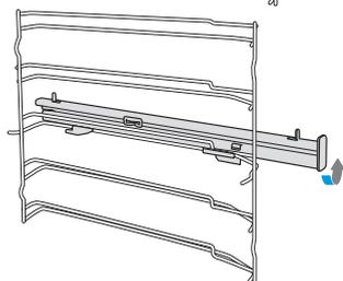
3. Задвиньте вперед телескопические направляющие, закрепите выступ С на нижней опоре, а выступ D – на верхней.
