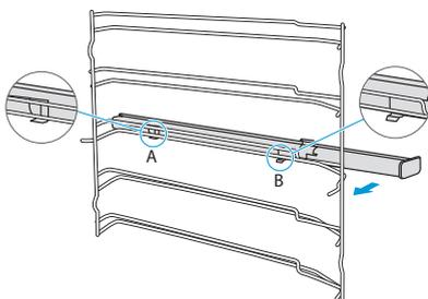
2. Поверните телескопические направляющие против часовой стрелки (по часовой стрелке для правой стороны) на 90°.
