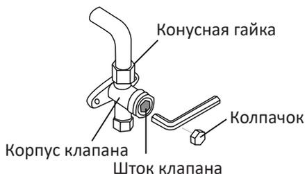
12. Используя шестигранный ключ, полностью откройте клапаны высокого и низкого давления.
