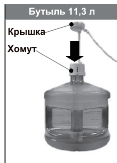
Рис.3 Установка сифона на бутылку с водой
