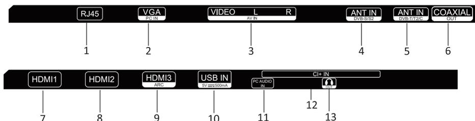
1. Разъём локальной сети LAN RJ-45. Для подключения сети используйте кабель LAN со штекером RJ-45 (в комплект поставки не входит).
