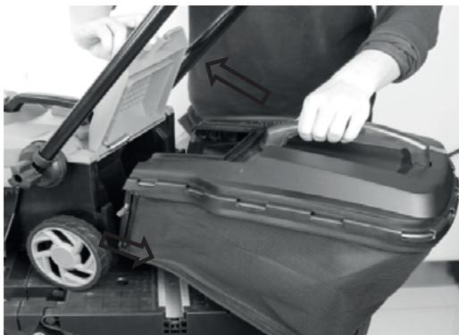
2. Разблокируйте фиксатор с обеих сторон, повернув его против часовой стрелки, а затем сложите верхнюю часть рукоятки. Поворачивайте по часовой стрелке, чтобы разблокировать, и против часовой стрелки, чтобы зафиксировать рукоятку.
