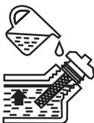
Не запускайте двигатель мотокультиватора без воздушного фильтра и с незаправленной маслом ванночкой, в противном случае неизбежна поломка двигателя.
