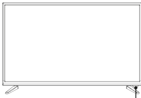
Датчик ДУ/ Индикатор питания / Кнопка питания
