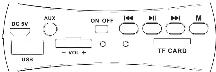
1. DC 5V Разъем для подключения USB кабеля для зарядки батареи
