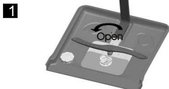
ШАГ 1. Поверните против часовой стрелки фильтр грубой очистки, вытащите его по направлению вверх
