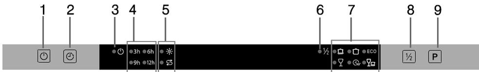
1. Кнопка вкл./выкл.: включение и выключение машины.
