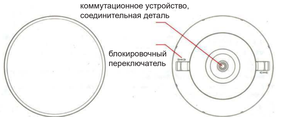
Фронтальная проекция арматуры (основания) светильника
