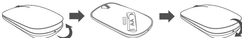
Откройте верхнюю часть корпуса по метке на задней части мыши, вставьте батарею AA в батарейный отсек и закройте верхнюю часть корпуса.
