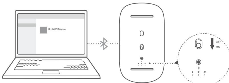
Перед использованием вам необходимо выполнить сопряжение мыши с устройством Bluetooth. По Bluetooth можно подключить до 3 устройств.
