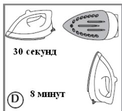
Үтікті автоматты сөндіру функциясы келесідей тәсілмен жүзеге асады: Белгілі бір температураға дейін қыздырылған, бірақ, қолданылмаған үтік, сондай-ақ, табанында жатқан немесе бір қырынан жатқан үтік 30 секундтан кейін автоматты тұрде сөнеді. Егер үтік пайдаланылмаса және таяныш-тіректі тігінен тұрса, - автоматты тұрде сөну режимі 8 минуттан кейін қосылады ( D сурет). Іске қосу режимін автоматты сөндіру жүреді миганием индикаторы қыздыру.
