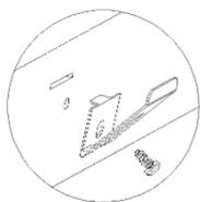
– Разместите варочную поверхность в вырезанном отверстии столешницы и аккуратно надавливая сверху углубите встраиваемую часть варочной поверхности в отверстие. При этом пружинные скобы быстрой фиксации упрутся в край столешницы и не будут давать возможность варочной поверхности выйти из отверстия установки.
