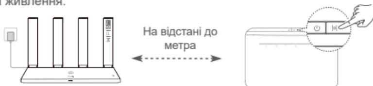
Крок 2. Коли індикатор HUAWEI CPE почне блимати, натисніть на ньому кнопку Н. Дочекайтесь сигналів індикатора, які свідчить про підключення маршрутизатора до мережі.
