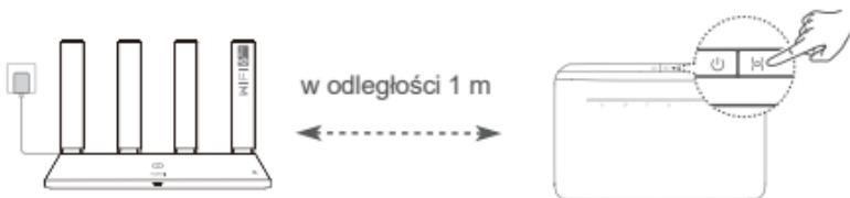
Krok 2: Gdy wskaźnik urządzenia HUAWEI CPE zacznie migać, naciśnij znajdujący się na nim przycisk H. Poczekaj, aż wskaźnik routera zasygnalizuje nawiązanie połączenia z siecią.
