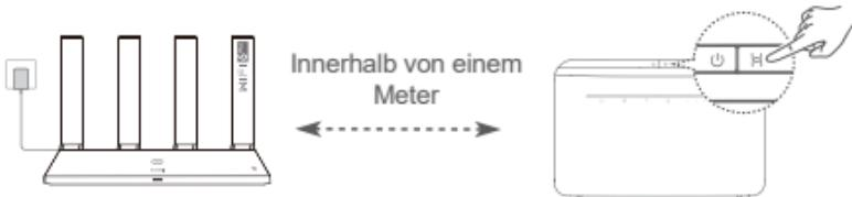
Schritt 2: Wenn die Kontrollleuchte am HUAWEI CPE zu blinken beginnt, drücken Sie dessen H-Taste. Warten Sie, bis die Kontrollleuchte am Router angezeigt, dass der Router mit einem Netzwerk verbunden ist.
