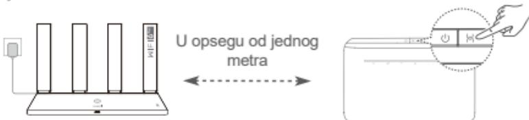
2. korak: kada indikator na HUAWEI CPE uređaju počne da treperi, pritisnite H taster na njemu. Sačekajte da indikator na ruteru pokaže da je ruter povezan na mrežu.
