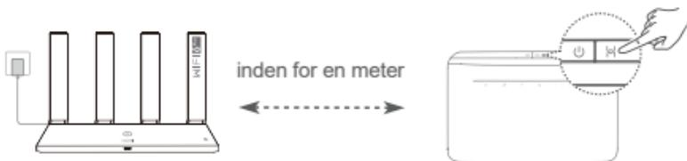
Trin 2: Når indikatoren på HUAWEI CPE begynder at blinke, skal du trykke på H-knappen på den.
