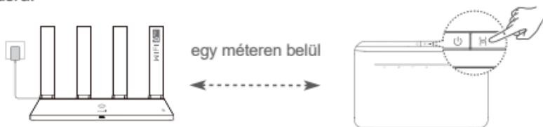
2. lépés: Amikor a HUAWEI CPE készüléken található jelzőfény villogni kezd, nyomja meg rajta a H gombot. Várjon, amíg a router jelzőfénye azt nem jelzi, hogy a router csatlakozik a hálózathoz.
