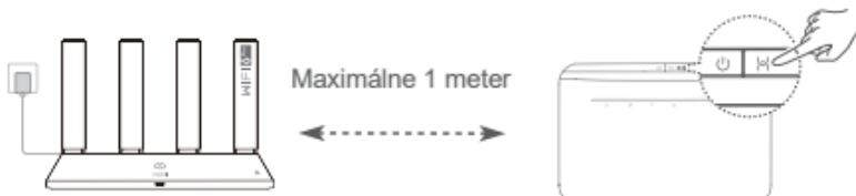
Krok 2: Keď indikátor na zariadení HUAWEI CPE začne blikáť, stlačte na ňom tlačidlo H. Počkajte, kým indikátor na smerovači nezobrazí, že je pripojený k sieti.
