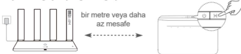
2. Adım: HUAWEI CPE cihazının göstergesi yanıp sönmeye başladığında üzerindeki H düğmesine basın. Yönlendiricinin göstergesi yönlendiricinin ağa bağlandığını gösterene kadar bekleyin.
